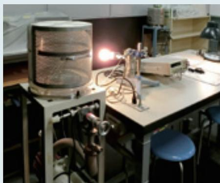
空気の振動で音の速さを調べる実験では、空気中の分子のぶつかりによって音速が 違うことがわかります。皆さん、ヘリウム ガスを吸うとアヒル声になりますよね。
