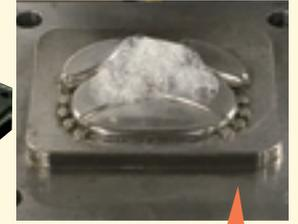
金属で出来たカニ型の口から泡が？不思議です。カニ型の一部分の金属の焼結密度を変えて加工成型、型の上に洗剤を塗り、型の下から空気を送り込むとカニの口から泡がブクブク。これぞスペシャル加工機の成せる技ですね。
