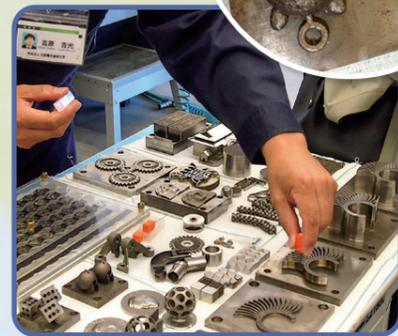
▶ 薄く敷き詰めた金属粉末にレーザーを照射して焼結しさらに金属粉末を積み重ねて造形加工する言わば金属の 3D プリンター機能と、レーザー光の焼結による加工では金属表面にざら
